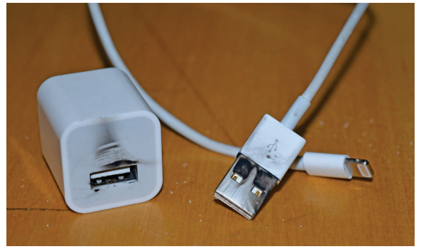
Denne originale iPhone 5s-laderen eksploderte ifølge fotografen i hendene på en kollega. For å være på den sikre siden, bør man altså unngå å lade ved sengen, selv med originalt utstyr. Foto: José Fonseca / CC 2.0
